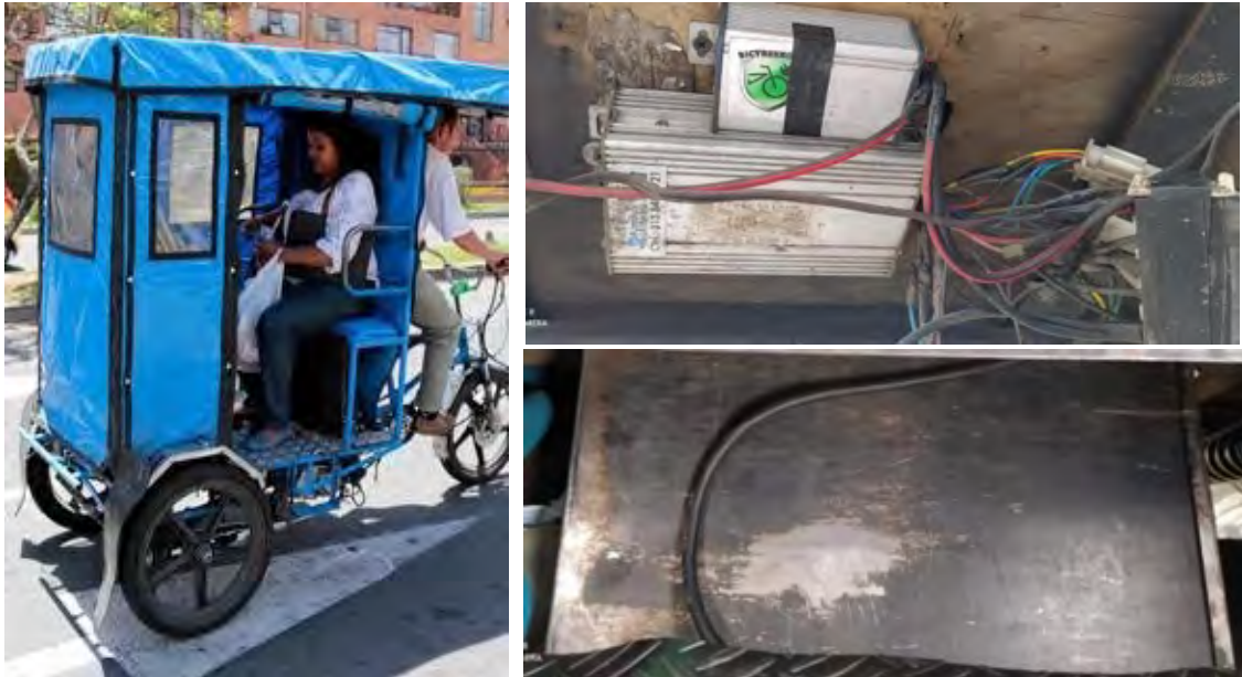
Figura 2. Bicitaxi convertido a eléctrico empíricamente, superior derecha controlador de carga, inferior derecha banco de baterías sin especificar.
