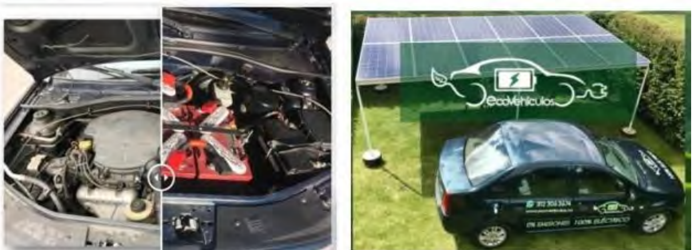
Figura 5. Conversión de un Renault logan de combustión a eléctrico [3]
