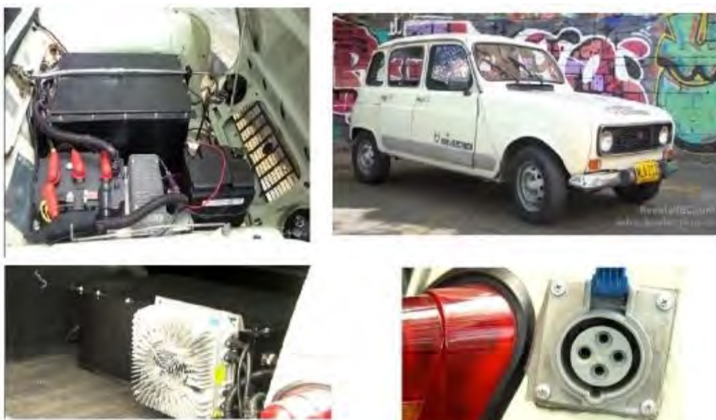
Figura 6. Conversión de un Renault 4 de combustión a eléctrico. [4]
