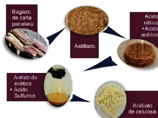
Fig.1 Esquema de la metodología para la obtención de acetato de celulosa a partir de biomasa.
