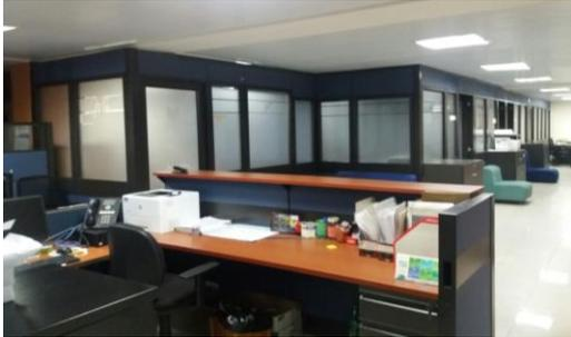
**FOTO 5:** Suministro e instalación de recepción dim 2,50 x 0,60 mts. Frente elaborado en lamina de acero cr. Cal 22/16 acabados con pintura en polvo epoxipoliéster de aplicación electrostatica color nopal.
