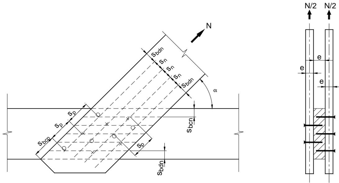
Figura G.6.7-1 B – Espaciamiento de clavos para cortante doble
