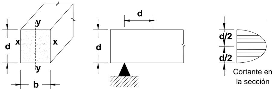
Figura G.3.4-1 — Esfuerzo Cortante en vigas.
