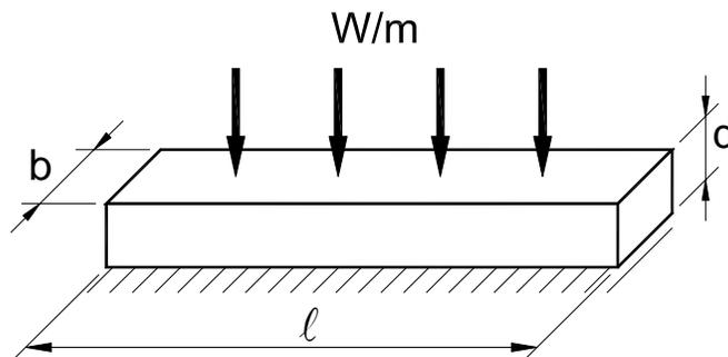
Figura G.3.5-2 — Deformabilidad por aplastamiento
