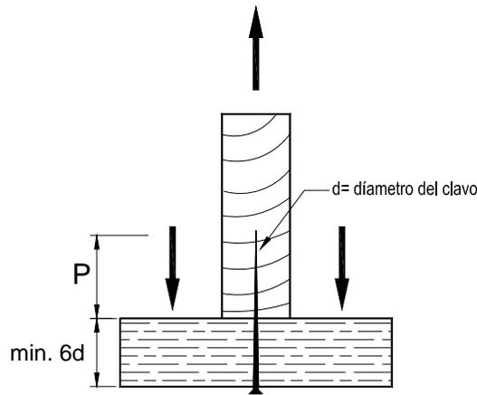
Figura G.6.12-1 — Elemento principal — Clavo con carga de extracción
