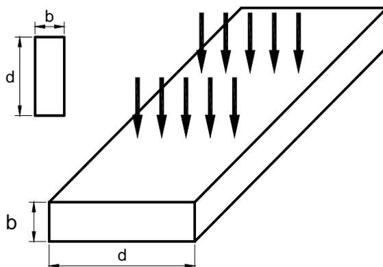
Figura G.3.3.1 — Colocación de la carga en cara ancha
