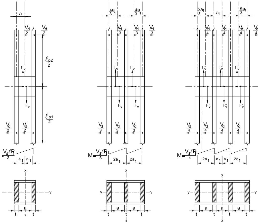
Figura G.4.3-4 — Suposiciones relativas a los puntos de acción de las fuerzas de cortante y flujos de cortante en piezas compuestas con tapas de unión
