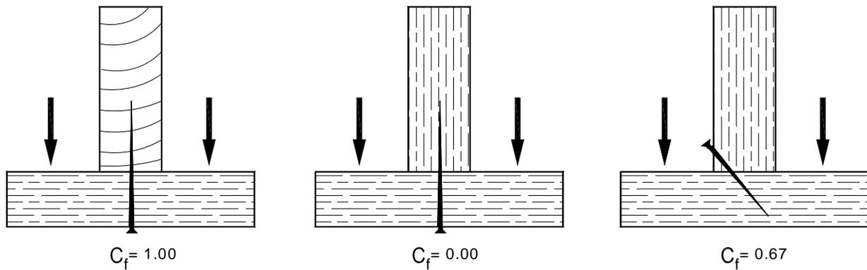
Figura G.6.12-2 — Factor de colocación
