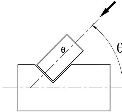
Figura G.3.5-1 — Cargas inclinadas
