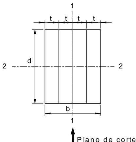
**Figura G.4.3-6 — Sección transversal de columna armada**
