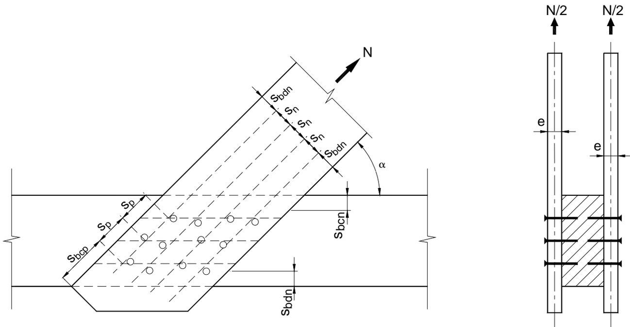
**Figura G.6.7-1 A – Espaciamiento de clavos para cortante simple**
