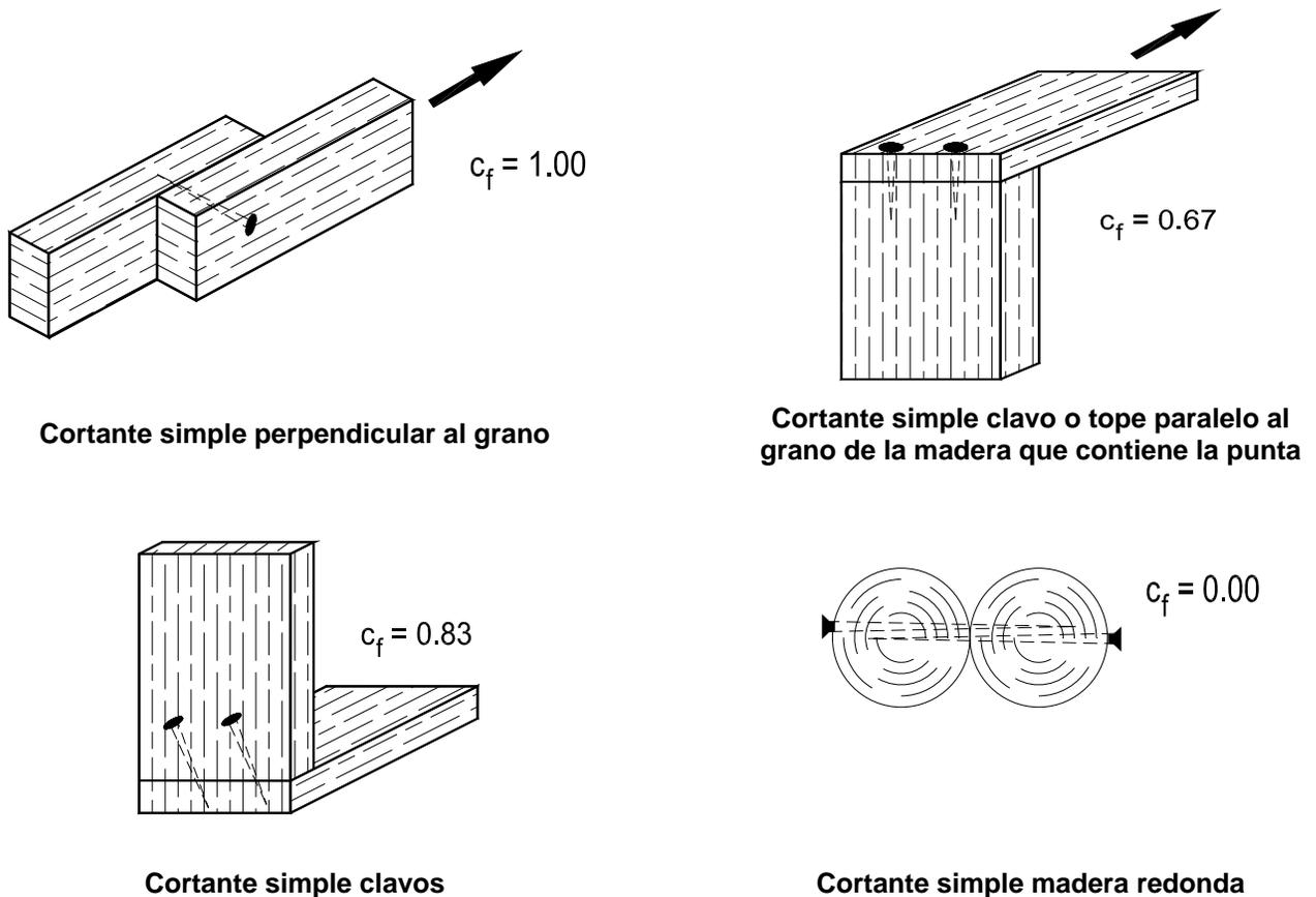
Figura G.6.11-1 - Coeficiente de forma
