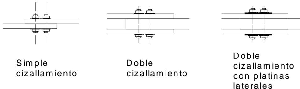
**Figura G.6.13-1 — Uniones emperradas de dos o más elementos de madera**
