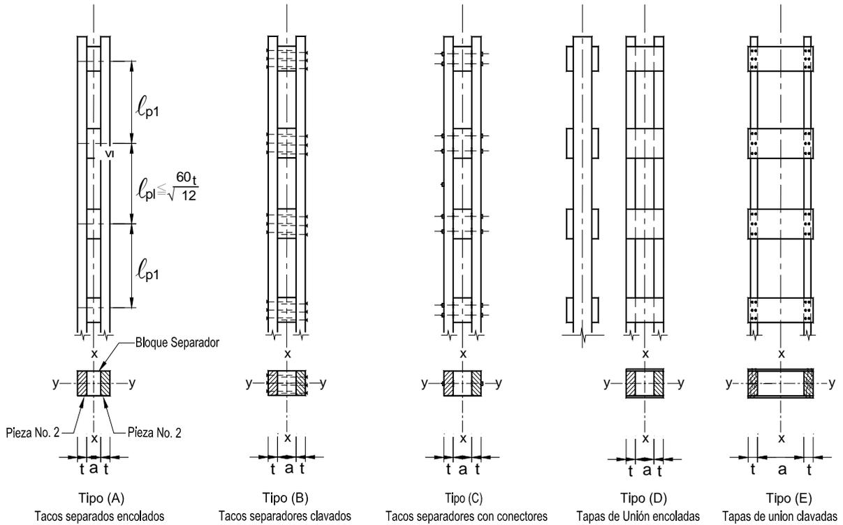
Figura G 4.3-3 — Columnas compuestas espaciadas
