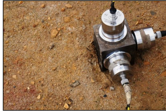
Figura 3. Instrumentación en campo. Arreglo triaxial de acelerómetros.
