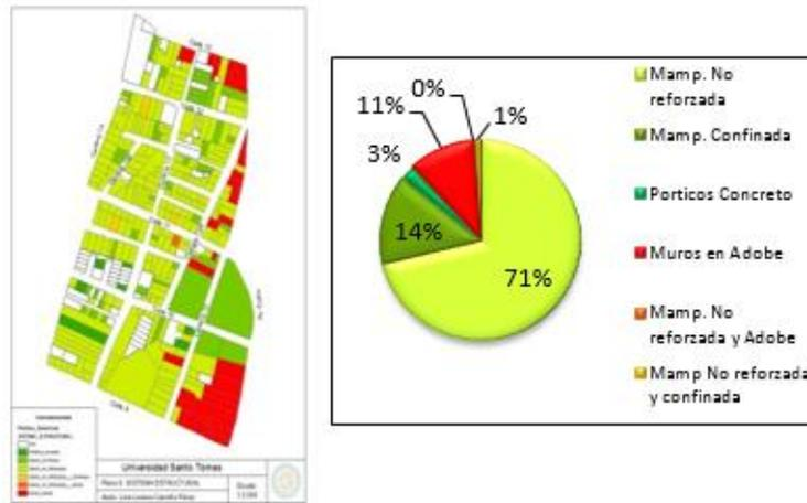
**Figura 2.** Sistema estructural
