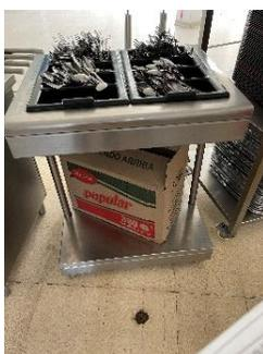
**A-2013-251400** Carro transportador en acero inoxidable: de tres bandejas medidas: 100cm de alto x 70cm de ancho x 90 cm de largo bandejas en calibre 18 estructura en tubo redondo en acero inoxidable de 1" con ruedas en teflón con freno
