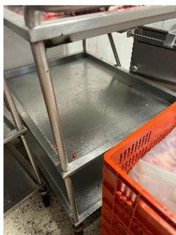
**A-2013-251401** Carro transportador en acero inoxidable: de tres bandejas medidas: 100cm de alto x 70cm de ancho x 90 cm de largo bandejas en calibre 18 estructura en tubo redondo en acero inoxidable de 1" con ruedas en teflón con freno
