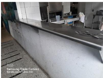
A-2013-251363 Mesón con una poceta: medidas en acero inoxidable: 200 cm de largo x 80 cm ancho x 90 cm de alto; poceta de 90cm x 65cm x 35cm de profundo: cubierta en calibre 16; piso en calibre 18; pata de en tubo redondo en acero inoxidable 2" con patas niveladoras en aluminio fundido con llave de pedal y mezclador
