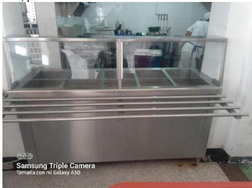
**A-2014-261372** Suministro e instalación de modulo para ensaladas en dos azafates. Medidas 80 cms de largo x 65 cms de ancho x90 cms de alto; barra deslizadora de 40 cms de ancho en tubo redondo de 1", azafates de 53cmsx32cms, capacidad 19 litros con tapa repisa con vidrio anti estornudos en 5mm cubierta en calibre 16 ref 304, cuerpo y piso en calibre 18 ref 304, patas en tubo redondo de 2" con niveladoras en aluminio fundido.
