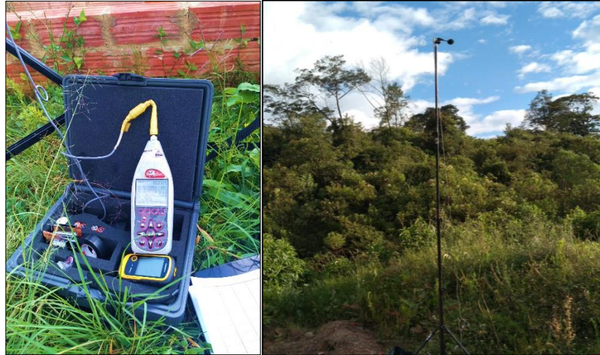
Figura No. 4 – Equipo de Medición de Ruido y Montaje Respectivo
