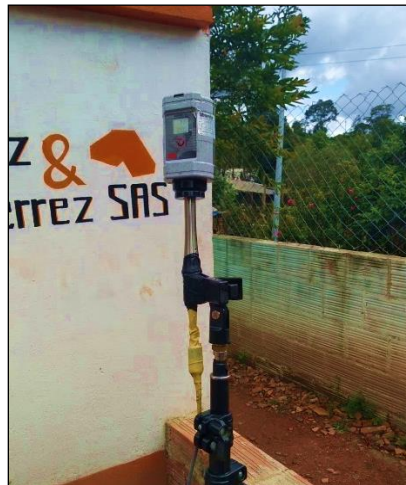
Figura No. 5 – Procedimiento Calibración Acústica Del Sonómetro en Campo
