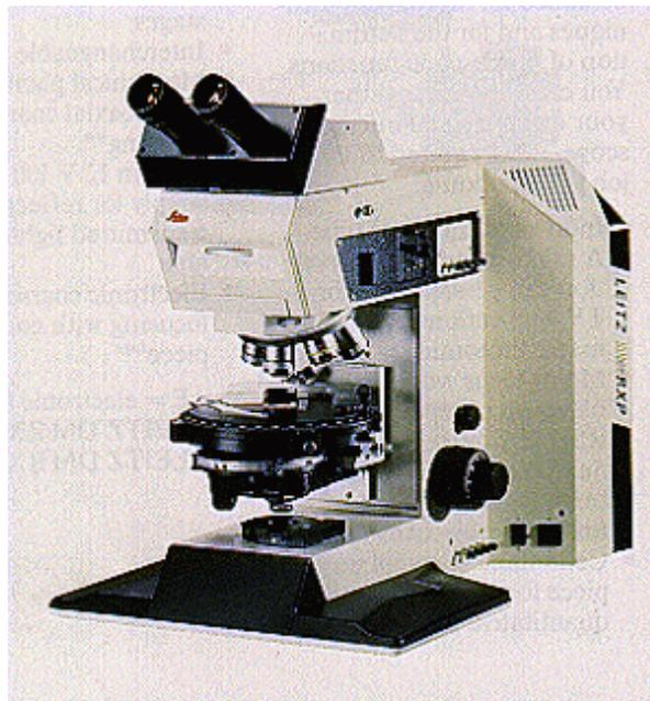
**Figura 12.** Microscopio petrográfico o de polarización perteneciente al INCITEMA
